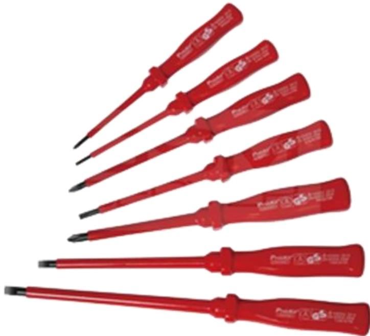
Per gli attrezzi di lavoro a mano per lavori sotto tensione fino a 1000 V in corrente alternata e 1500 V in corrente continua, la norma **CEI 11-16** (CEI EN 60900) prescrive le dimensioni, gli isolamenti e le prove che gli attrezzi devono superare per essere ritenuti sicuri nei lavori sotto tensione.
